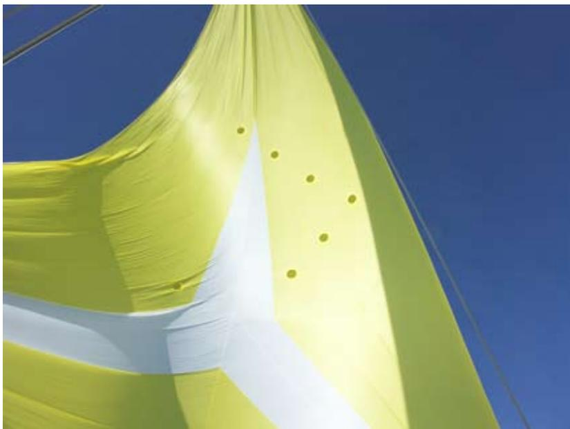
Stoßdämpfer. Der Öffnungsschlag beim Öffnen des Paragen wird durch die "Überdruckventile" wirkungsvoll gedämpft, dies schont das Rigg und die Nerven der Crew.
