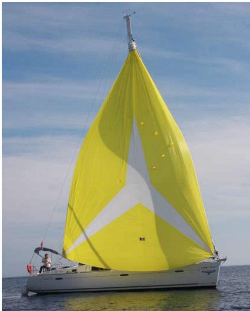
Ein Raumwindsegel muss über genügend Quadratmeter verfügen, um die Yacht auch bei Leichtwind gut zu beschleunigen. Der asymmetrische Paragen verfügt fast über die Fläche des Spinnakers.
